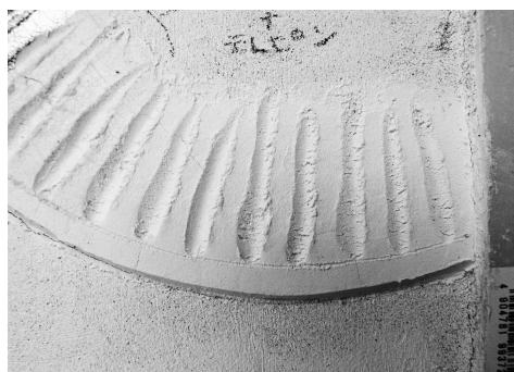
大理石粉を混入した実験（木目が細かく亀裂がほとんどみられない）
